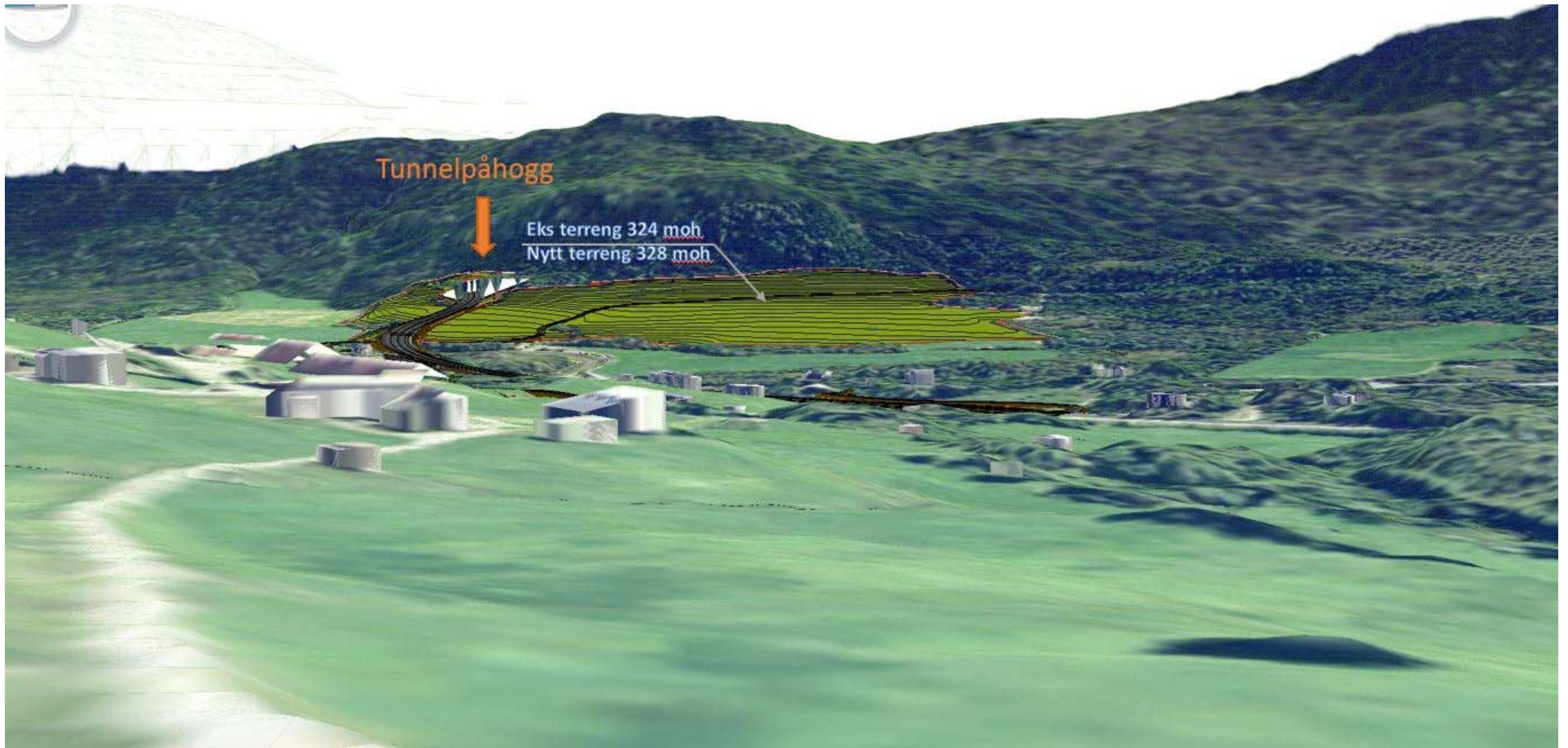
Augepunkt 1 : Viser ny veg og deponiområda ved tunnelpåhogget
