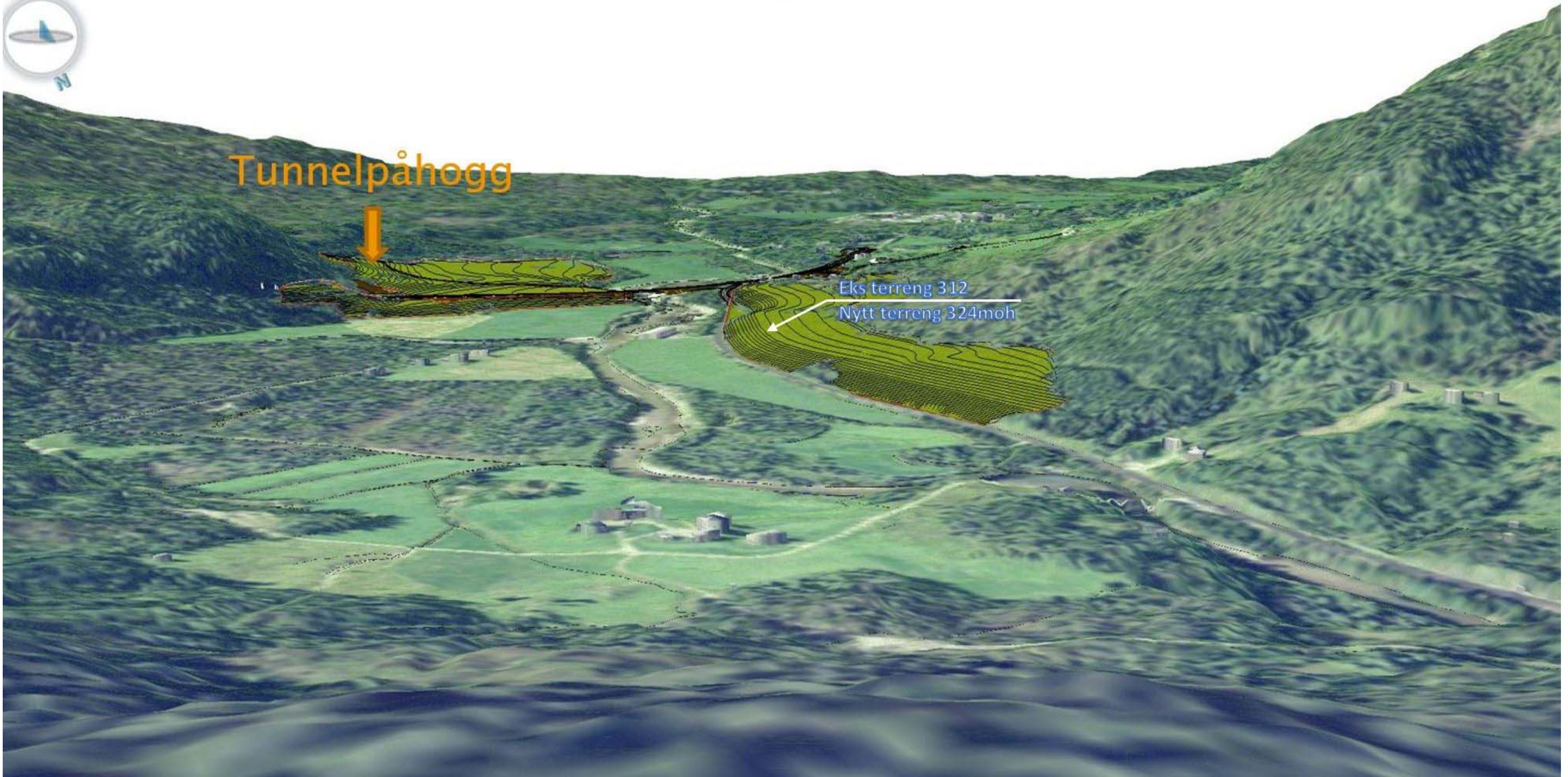
Augepunkt 5: Veganlegget med deponia sett frå fjellet over Øvsthus. Illustrerer omfang at deponiet langs E16 får ei jamn dalside mot vegen med eit flatare område oppå.
