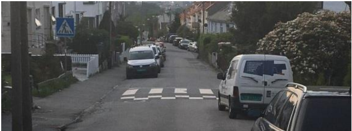
Figur 14 – Parti i Søndre Skogvei, uoversiktlig gangkryssing pga. beplatning og parkeringsrekke på høyre side i bussens retning. (Foto: Rambøll)
