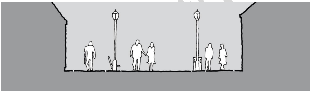
Figur B.7: Gågate med veggsoner, møbleringssoner og ferdselssoner
