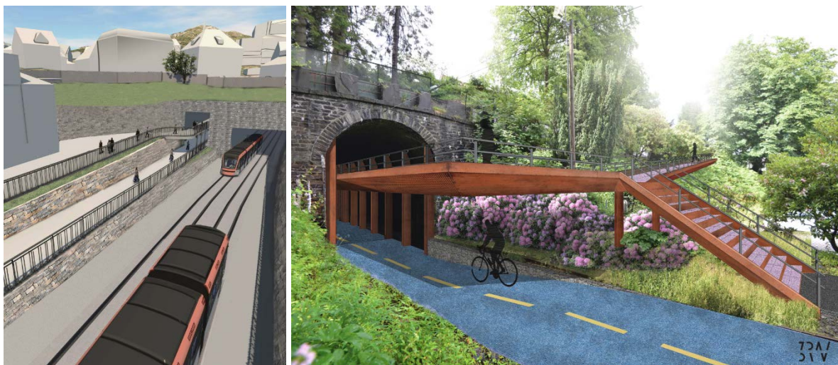
Skisse av mulig løsning ved tunnelportalene Kronstad og Møllendal med en toplansløsningen, sykkel nede og fotgjengere oppe. Alternativ Hovedrute + gangtilbud og Sykkelekspressvei + fullt gangtilbud
