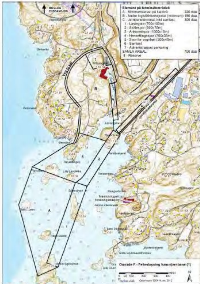
Figur 36 - Forslag til kombinert hamne- og jernbaneterminal i delområde F. Også andre utformingsprinsipp er mulige, t.d. ytterligere ekspansjon mot sør, i steden for område B i nord.
