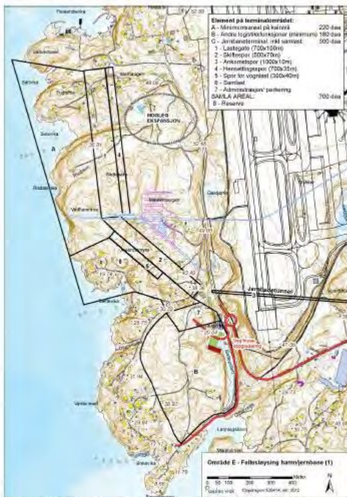
Figur 35 - Forslag til kombinert hamne- og jernbaneterminale i delområdet E. Også andre utformingsprinsipp er mulige, t.d. ekspansjon mot aust (høgare nivå), i steden for område B i sør.
