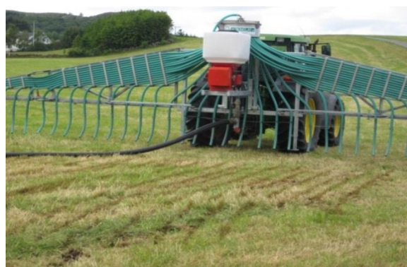
Miljøvennlig gjødselsspredning, med nedfeller. Foto: Fylkesmannen i Rogaland
