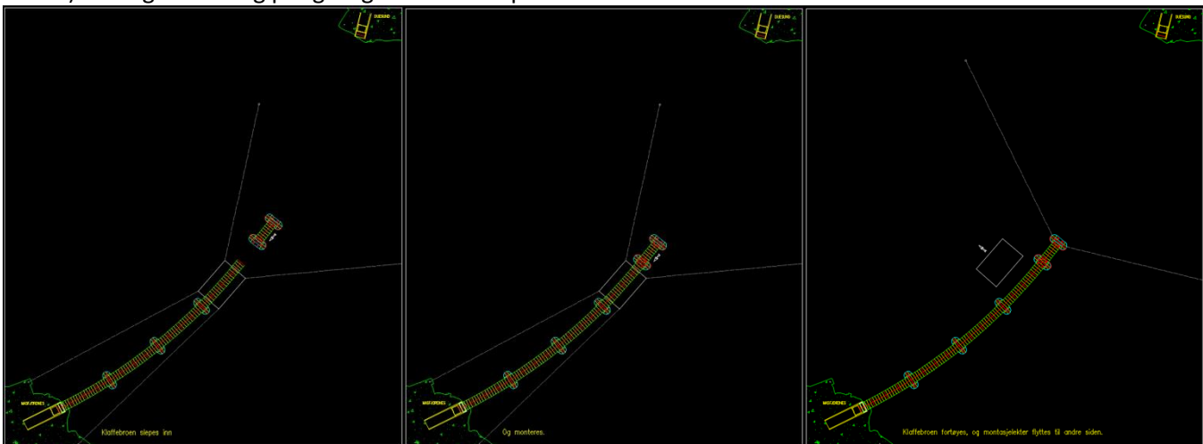
12 -15) Skipspassasjen flytes på plass, monteres og fortøyes. Første ende fra land er nå klar.
