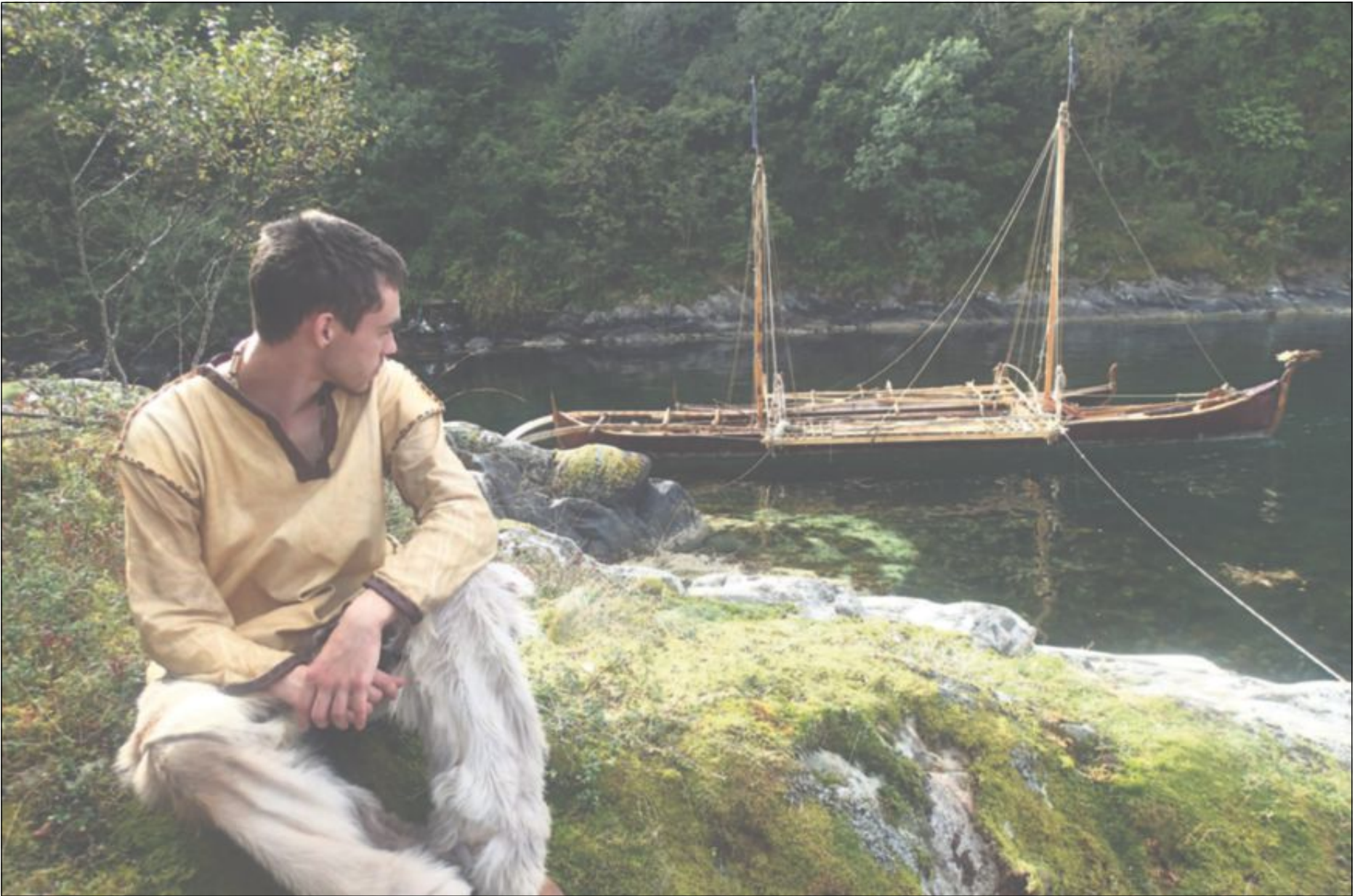
SKINNBJÅT: Børje Møster har bygt skinnbåten Havelgen etter inspirasjon frå helleristningar frå stein- og bronsealder. Det er brukt eik, furu og lerk frå distriktet, og naturfibertau og selskinnsreimar til å surra på spant av hassel og rogn. Deretter er det sydd saman tju elghuder på dei to skroga. Råseglet er sydd av tolv reinskinns-huder. Den kan padlast og
