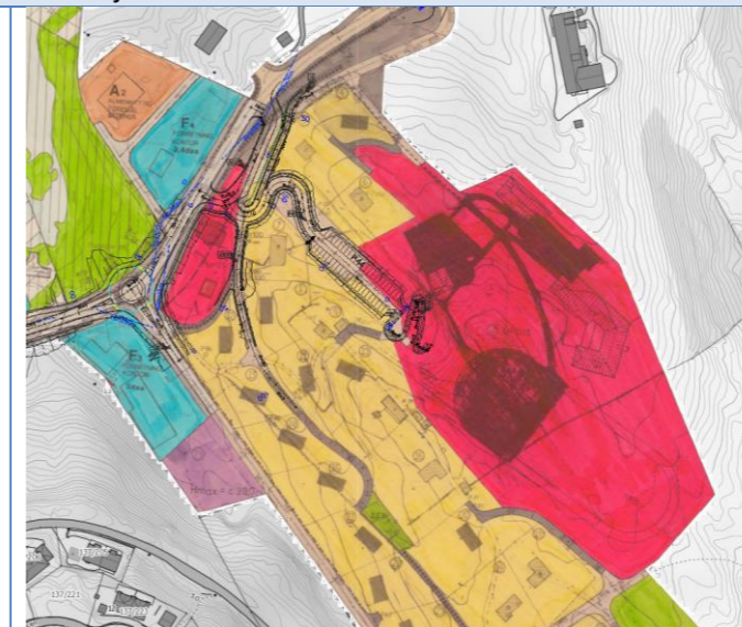
Figur 4 Gjeldande plan Vardalen planID 504_2 for same området med prosjektert forslag til ny vegsituasjon som referanse. Her er regulert skuleområde vist i raudt og trafikkareal vist i grått.
