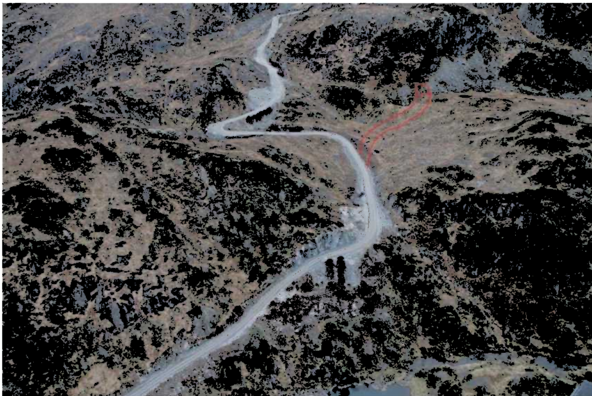
Figur 4.2. Påhogg til tverrslag Underlio. Biletet viser eksisterande veg opp til Vetrhusvatna. Ny veg og påhogg er markerte med raudt. Den nye vegen vil verta om lag 75 m lang.
