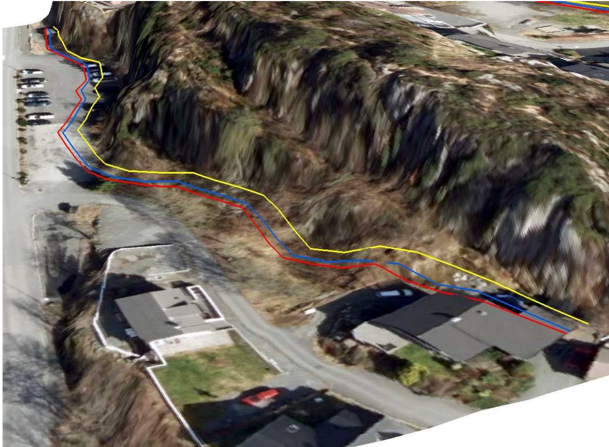
Figur 12 3D illustrasjon av område 3. Faresonegrenser er vist, 1/100 med gult, 1/1000 i blått og 1/5000 i rødt. Løsneområdet er brattskrenten til høyre i bildet.
