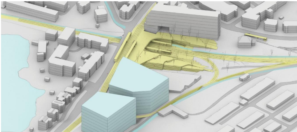
Figur 4 Variant 2B. Eksisterende og helt eller delvis planavklarte bygninger i grått, nye bygg markert med blått. Nye bygg øst for eksisterende linje er eksempler på mulige volumer, disse er ikke planavklart
