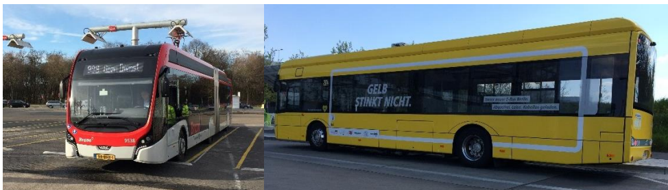
Figur 2-5 Hurtigladede batteribusser. T.v. 18-meters leddbuss i Eindhoven. Konduktiv lading. Produsent VDL/Heliox. T.h. 12-meters standardbuss i Berlin. Induktiv lading. Produsent Solaris/Bombardier. Foto: Hannes Englessen.
