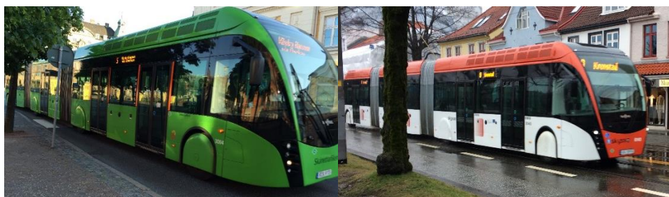
Figur 2-2 24-meters gasshybridbusser ruller i dag i Malmö (t.v.) og Bergen (t.h.). Produsent Van Hool. Foto: Hannes Englessen.
