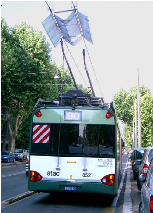
Figur 1 – Automatisk påsporing med hjelp fra skjermer over KL-anlegg
