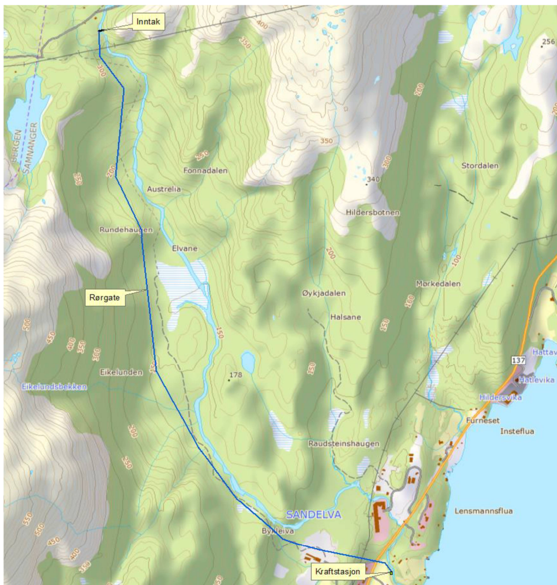
Oversiktskart av planlagt inntak, rørgate og kraftstasjon.
