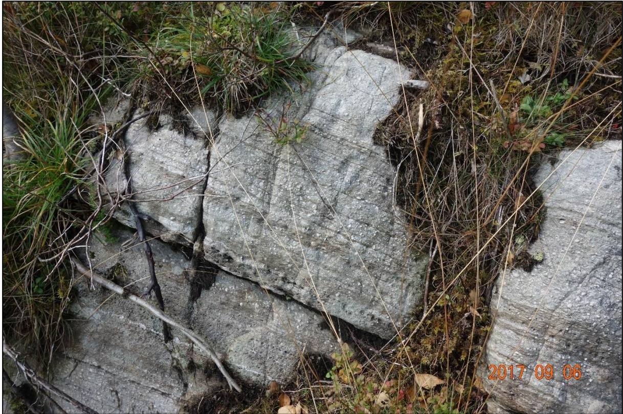
Figur 17: Banda gneis ved planlagt brufeste på Haganeset, Fjelbergøy.
