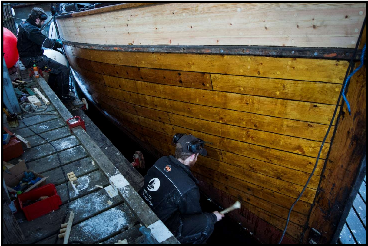
Tjære smøres "vått-i-vått" for å få tilnærmet samme glød som resten av
