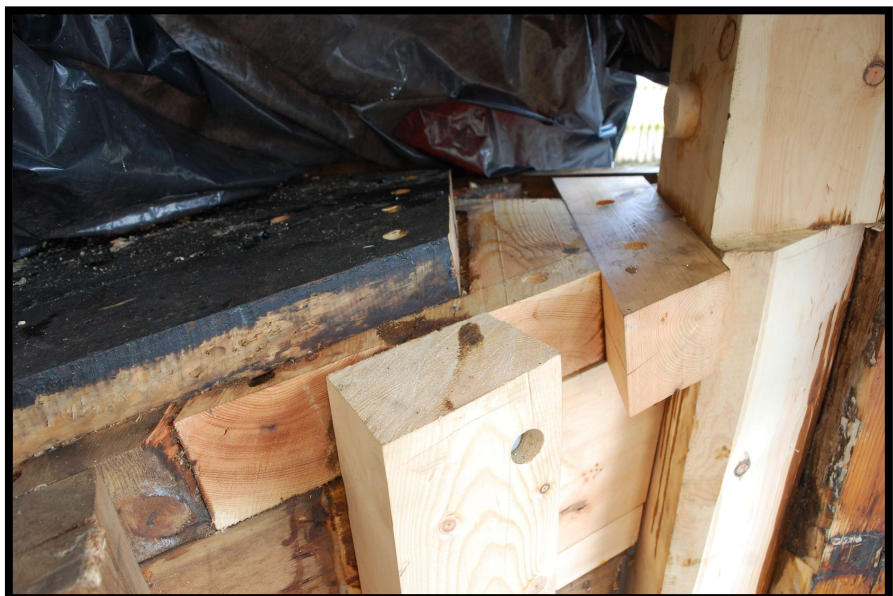
Ny deler av kneet, spantetoppen, spunnet bjelkeveger og øvre del av innerstevn.
