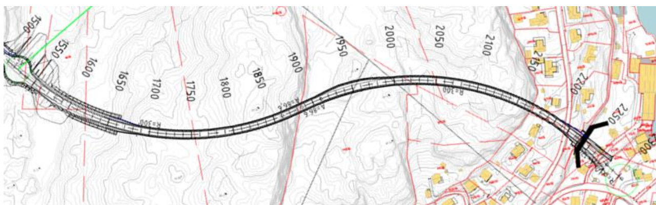
Figur 5.2 Forløb og placering af Hetleviktunnelen, vest er mod højre (stigende profilretning).
