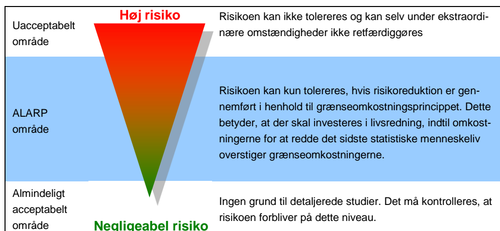
Figur 4.1 ALARP område og øvre grænse (omformulering af ALARP princippet til at gælde grænseomkostningsprincippet).
