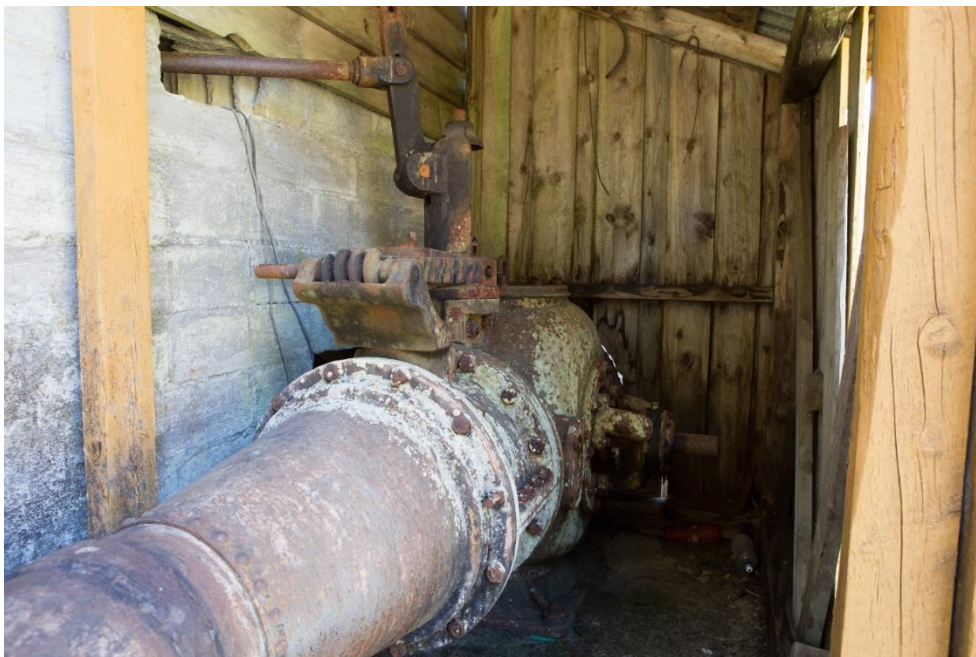
Fransisturbinen frå Sørumsand Verk står framleis i Nes bygdesag. Foto: Dag Endre Opedal/NVIM
