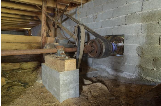
Venstre: Dokumentasjon av saga saman med eigar Kåre Nes. Høgre: Akslingen frå turbinen, med reimene som går opp til saga. Foto: Knut Markhus og Dag Endre Opedal/NVIM
