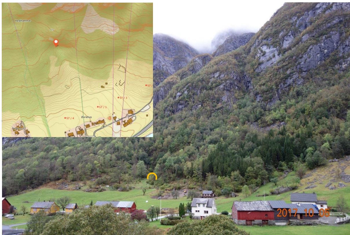
Figur 14. Skissert plassering av påhogg H. Krev mykje graving både innover til berg og til sides for å komme inn til berghammaren som er øvst i søkket.
