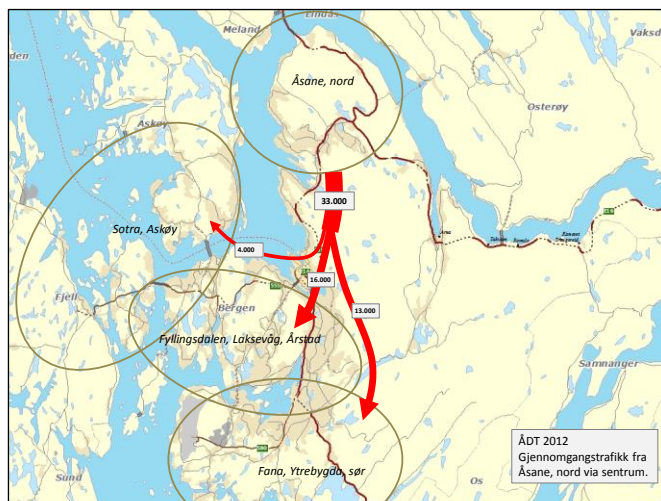
Figur 26. Dagens trafikkmengder (ÅDT) mellom Åsane/nord og Bergen sør og vest (gjennomgangstrafikk som i dag kjører via sentrum)
