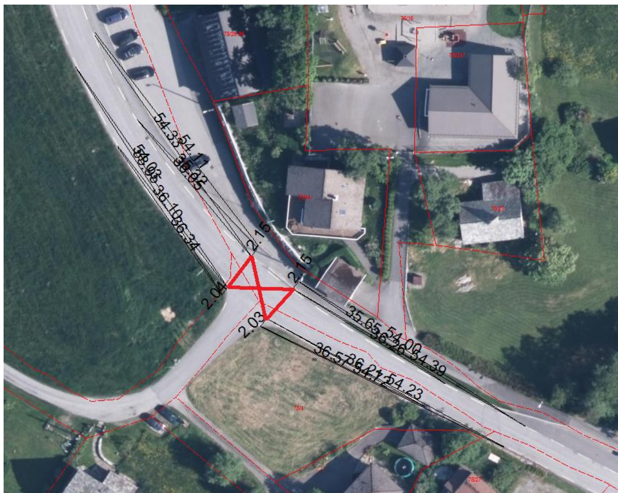
Figur 4: Ortofoto påført kryssingspunkt for gåande med siktsoner for høvesvis 40 km/t og 50 km/t.
