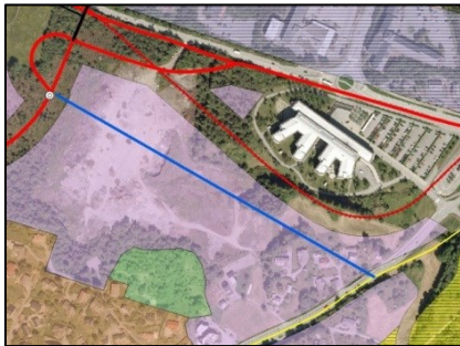
Figur 6. Prinsipp for en ny vegforbindelse (vist med blå linje) mellom nytt kryss ved Kokstad og Ytrebygdsvegen.
