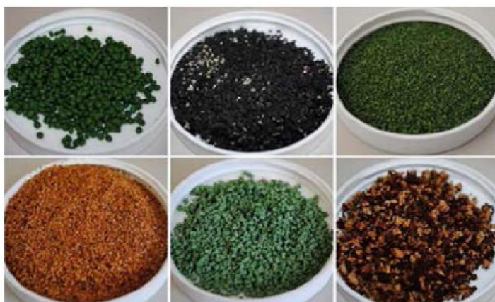
Figur 1 – Ulike typer granulat som finnes på markedet ifølge NFF [2].
