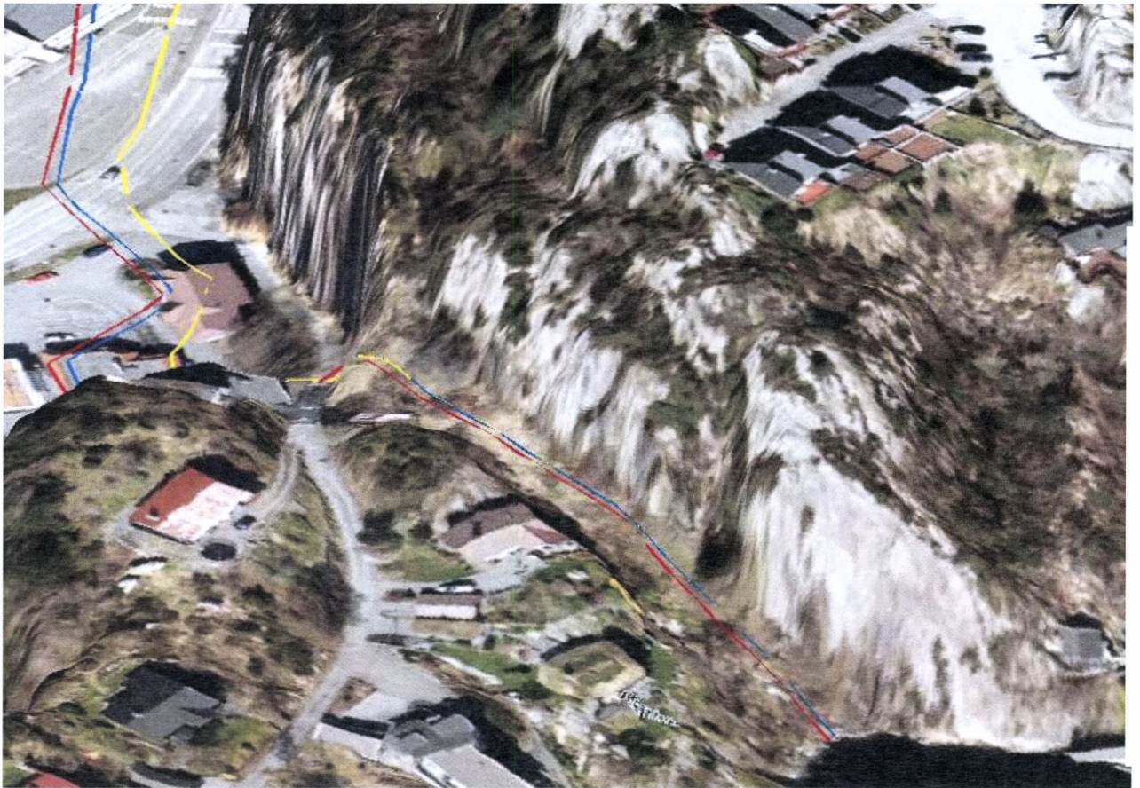
Figur 22 3D illustrasjon mot nord. Faresonegrenser er vist, 1/100 med gult, 1/1000 i blått og 1/5000 i rødt. Utløpsområdet er toppen av brattskrent til høyre i bildet.
