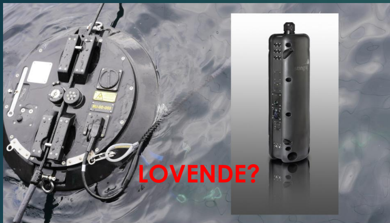
Bare toppen av bøyene skimtes på overflaten i merdene. Under henger noden som skyter lakselus automatisk med laser, helt ned til 30 meter. Foto: Stingray Marine Solutions
