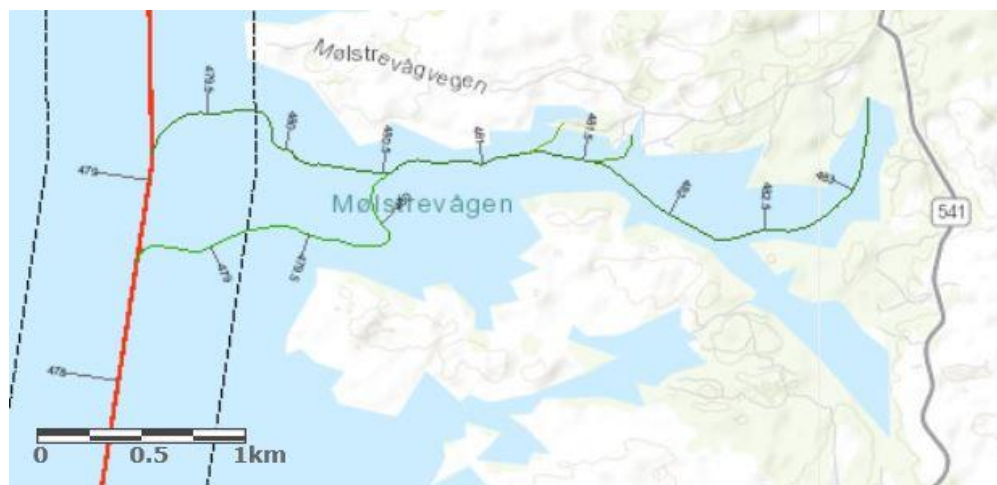
Figur 3-14. Mulig ilandføringspunkt for fiberkabel.
