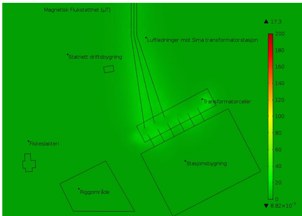
Figur 5-2 Magnetfelt med fokus på grenseverdi for offentlige områder på 200 µT, plan.
