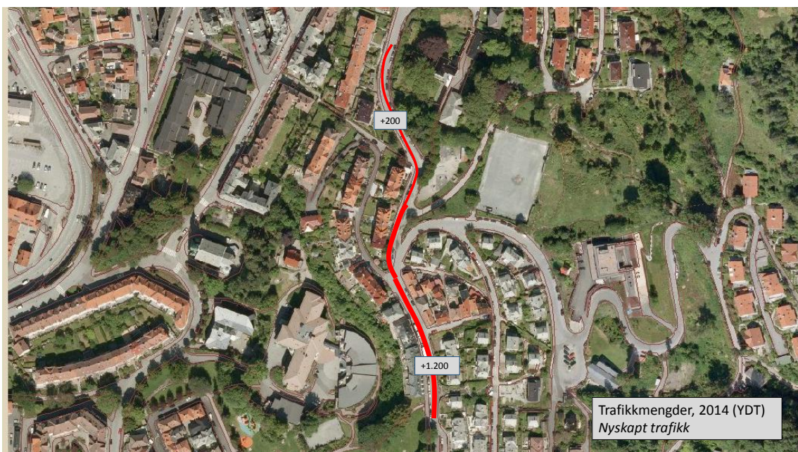
Figur 3. Beregnet nyskapt trafikk som følge av utbyggingen (YDT).
