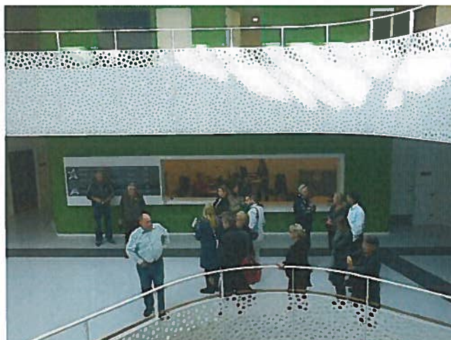
Figur 10 Taktile ledelinjer i åpne gulvflater med varierende veggavgrensinger (foto:L.Aasness)
