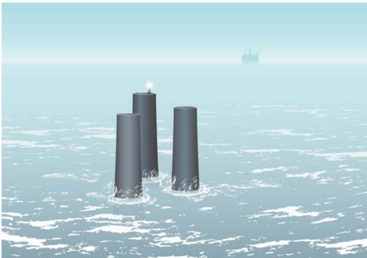
Figur 2-7 Etterlatelse av betongskaft med påmontert navigasjonslys
