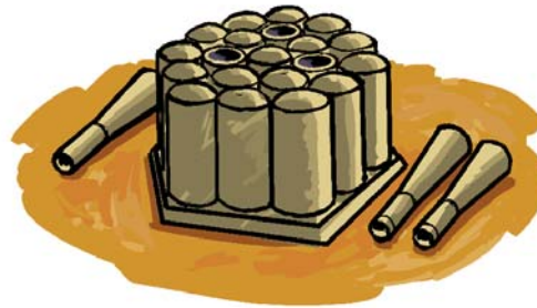
Figur 5. Illustrasjon av etterlatelse av betongunderstell inntakt og med navigasjonslys, og kuttet ned til lagercellene. Eksempler fra Frigg Avslutningsplan, hvor illustrasjonen til venstre angir valgt løsning på Frigg. Kilde: Total E&P Norge AS.
